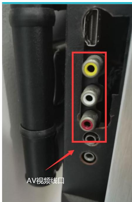
AV 视频线的三色线颜色对应着电视机上的颜色接口插进去，颜色不要插错
