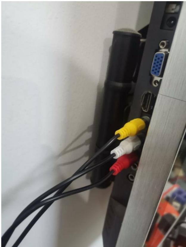
AV 视频线插好以后，用电视机遥控器切换一下电视机的信号源，把电视机信号源切换到 AV 视频信号界面，一般的 AV 视频信号界面的名称就叫“视频”或者 AV 信号源之类的，每个电视机或多或少都有差异存在。
