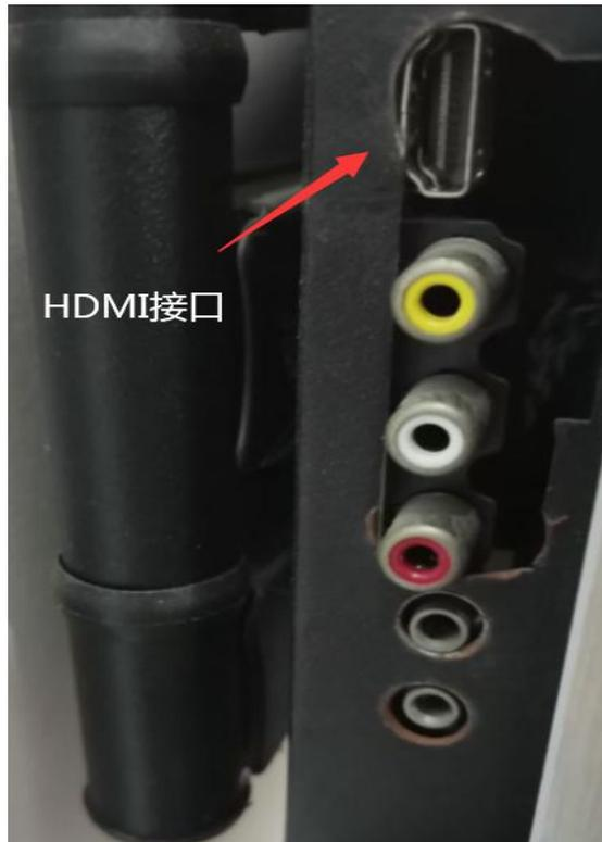
一般电视机上的 HDMI 接口就长这样，有的电视机会有两个，到时候线插了哪个接口，电视机信号源就切对应的那个 HDMI 信号接口
